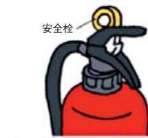
ストッパーが固定される様に安全栓を正しくセットする
