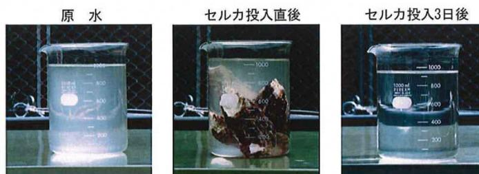
図- 2.1-36 牡蠣殻接触浄化剤の概要 (1)
