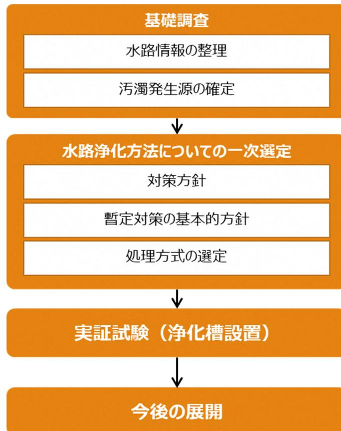
図- 2.1-1 河川浄化施設検討のフロー（国交省河川浄化の手引きを加工）
