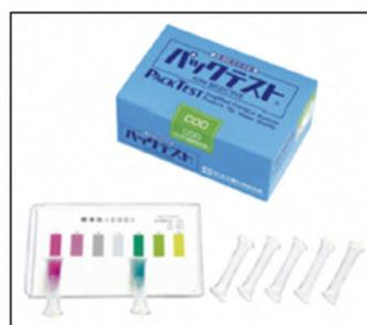
図 5.4.2 パックテスト実施状況およびパックテストセット例
