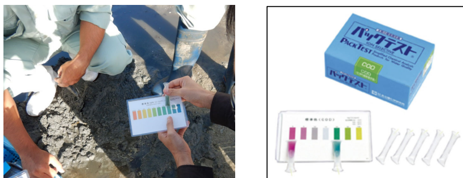
図 5.4.2 パックテスト実施状況およびパックテストセット例
