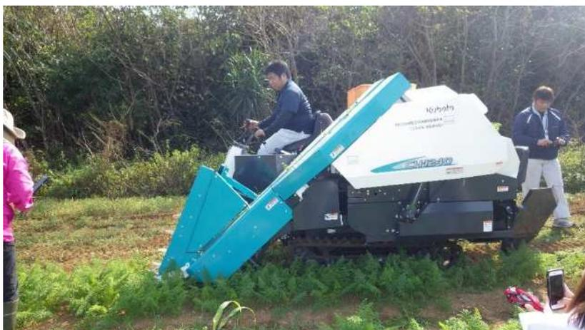
写真 4-1(1) 導入されたニンジン収穫機
