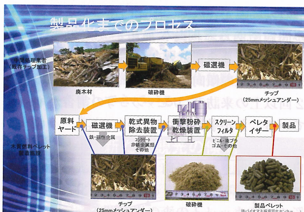
図-3 ペレット燃料製造工程
