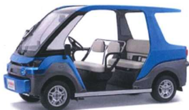
YG-M（ナンバー付） ・4人乗り ・最高速度：19km/h ・1充電走行距離 約40km
