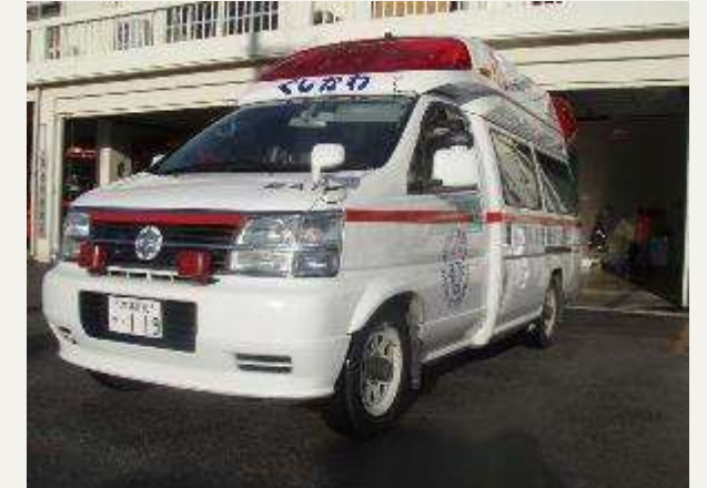
「2代目ニッサン パラメディック」 1992(平成4)年頃から最近50年頃まで運用され、フロントをエルグランド、後部を作業性向上させたキャンバンをベースに開発された専用ボディーの高規格救急車で、防振バットが搭載されています。
