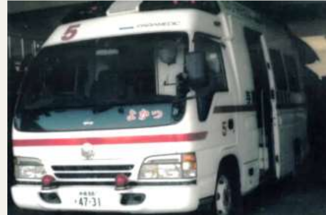
「初代ニッサン パラメディック」 平成8年から旧与勝事務組合消防本部で運用された高規格救急車です。高度な応急処置を行うため、広い活動スペースを確保し、トラックシャーシをベースにし、エンジンにディーゼルエンジンを搭載しています。
