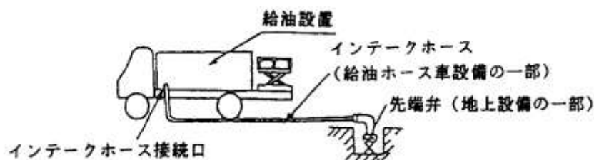
図6-36 給油ホース車のインテークホースの概要
