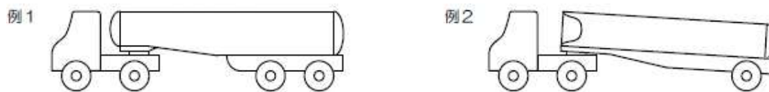
図3 被けん引車形式で積載式以外の移動タンク貯蔵所の例
