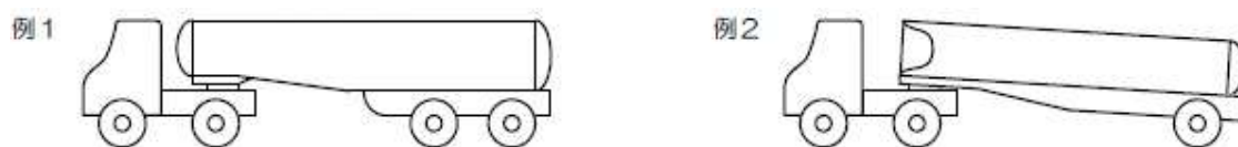
図3 被けん引車形式で積載式以外の移動タンク貯蔵所の例
