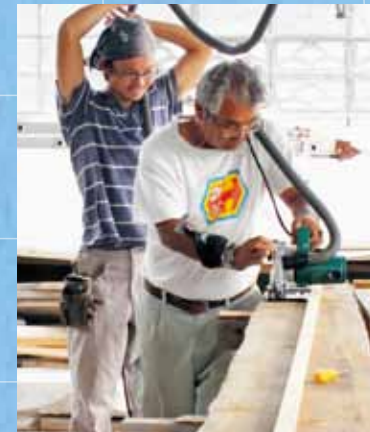
切る 墨を引いたところを切っていきます。長い木材を切る際は、電動のこぎりを使って切っていきます。
