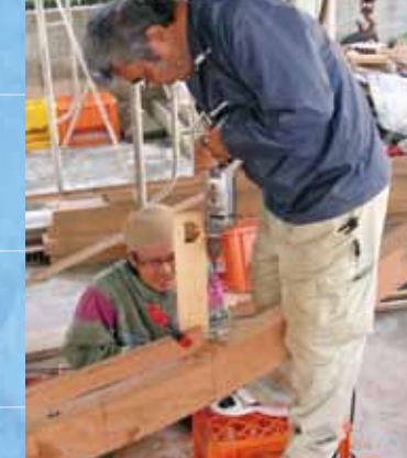
ミージョーロー（目測）の技 経験を積んだ船大工にしかできない技の一つです。船の測量はミージョーローと指矩を使って行われます。
