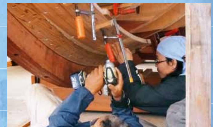
湯や水も火も使わず曲げる技 しめばたとつぱりを使って木を曲げていきます。
