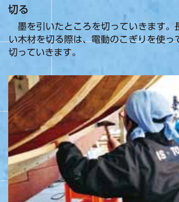
摺り合わせの作業 板と板とを密着させるため鋸をひきます。
