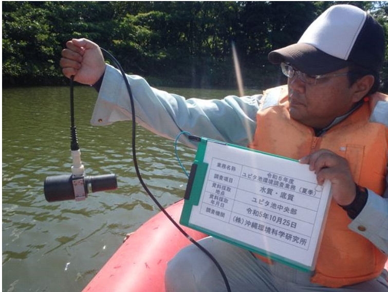
令和5年10月25日 夏季 水質・底質調査 濁度測定
