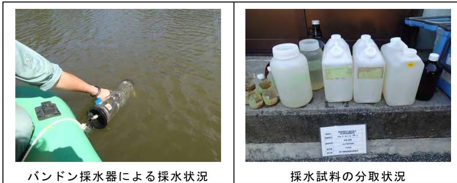
バンドン採水器による採水状況
