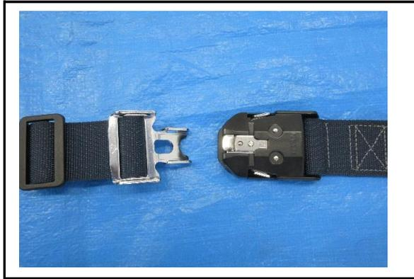
安全帯(墜落制止用器具)バックル
