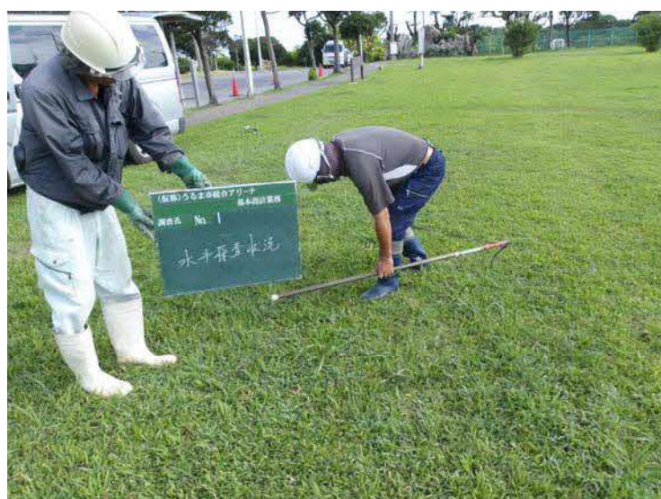
水 平 探 査 状 況
