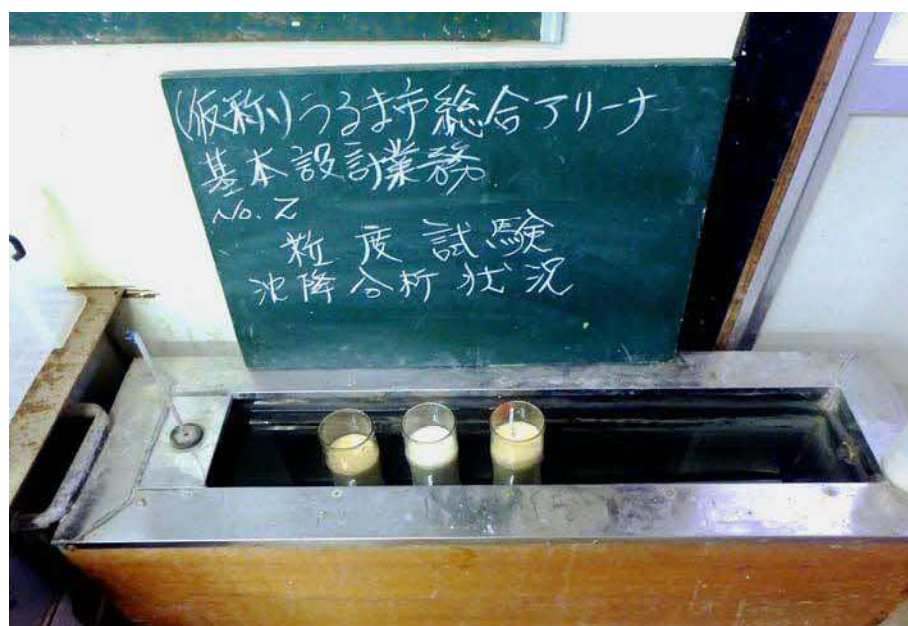
沈降分析状況
