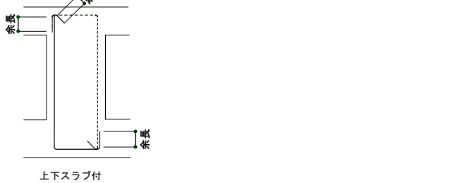
図2-3-6 副あばら筋・副帯筋の形状
