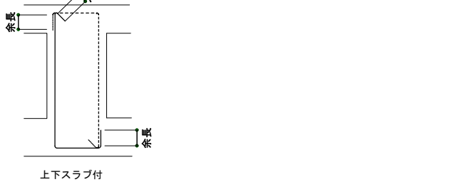
図2-3-6 副あばら筋・副帯筋の形状
