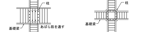
図6-4 基礎大梁と最下階柱の取合い部配筋要領
