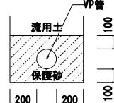
埋設管掘削図 S=1/10(A-1) 1/20(A-3)
