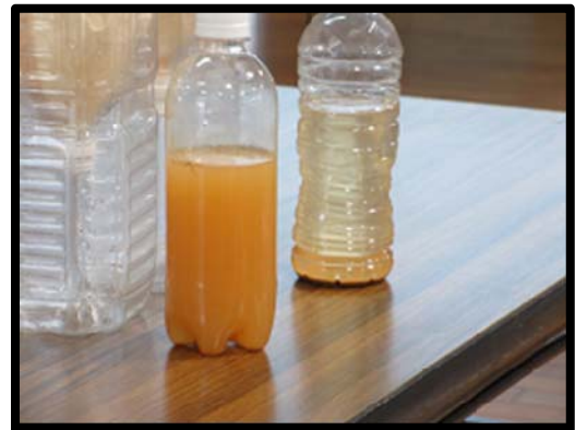
奥が凝集剤を添加したもの。赤土が分離してろ過しやすい状態になっています。
